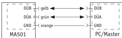
Abb. 8: Anschlusschema Schnittstelle RS485
