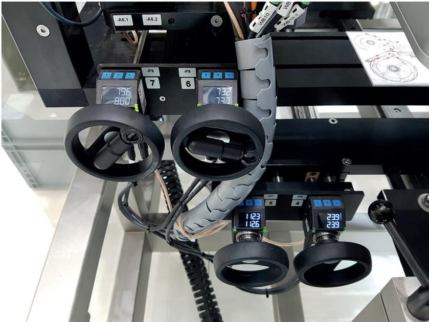
Abbildung 7: Busfähige elektronische Positionsanzeigen sorgen bei der Verpackung von Medikamenten für eine prozesssichere und effiziente Umstellung auf unterschiedliche Faltschachtelgrößen.
