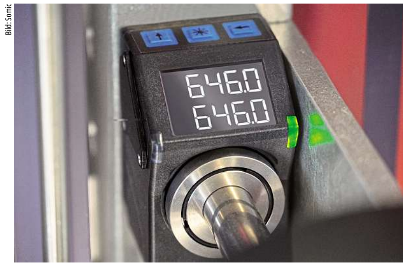
Die Positionsanzeige AP05 von Siko mit grüner Status-LED zeigt eine korrekte Maschineneinstellung.
