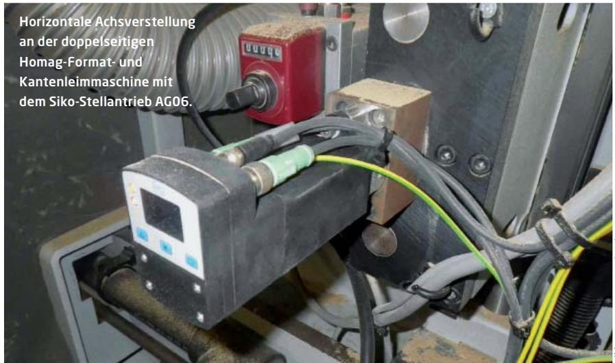
Horizontale Achsverstellung an der doppelseitigen Homag-Format- und Kantenleimmaschine mit dem Siko-Stellantrieb AG06.
