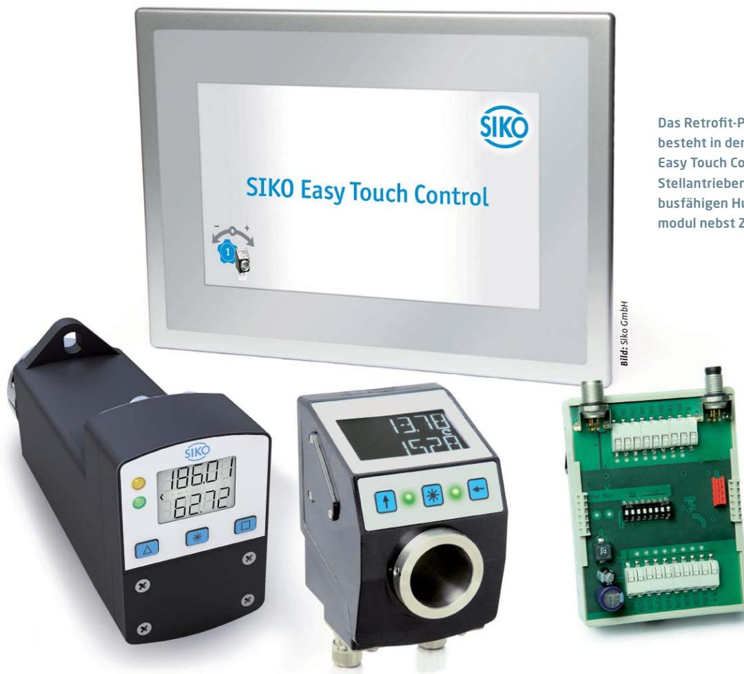
Das Retrofit-Paket von Siko besteht in der Regel aus dem Easy Touch Control, den Stellantrieben und einem busfähigen Hutschienenmodul nebst Zubehör.
