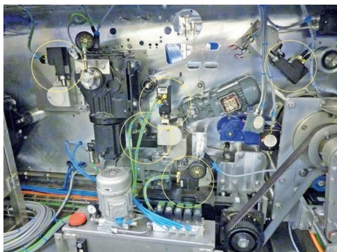
**03** Fünf Positionierantriebe sorgen in der Teigteil- und Wirkmaschine für automatisierte Formatwechsel
