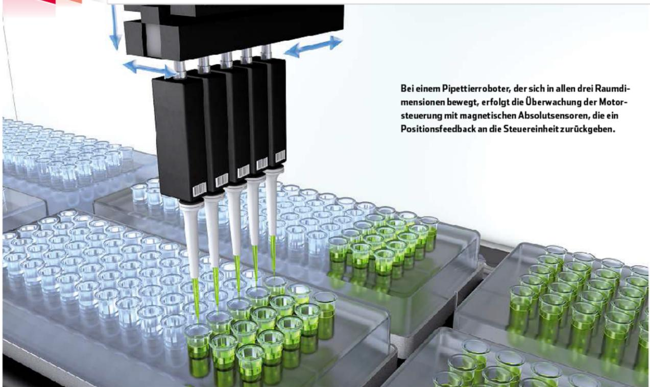
Bei einem Pipettierroboter, der sich in allen drei Raumdimensionen bewegt, erfolgt die Überwachung der Motorsteuerung mit magnetischen Absolutsensoren, die ein Positionsfeedback an die Steuereinheit zurückgeben.
