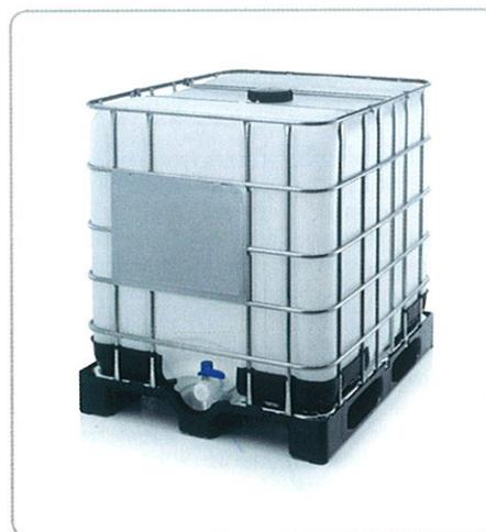
PE, der Rahmen ist verzinkt (geschweißter Stahlrohrrahmen). Die IBC-Container sind für Förderbänder, Hochregallagerung und Transport in ISO-Containern geeignet. Sie sind zudem witterungsbeständig und gut stapelbar – Lagerräume können so gut ausgefüllt werden. Die Außenmaße des Containers betragen 120 x 100 x 116 cm. Die integrierte Palette ist
