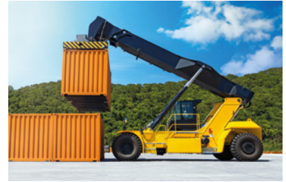
在正面吊上进行绝对值式和安全的转向角检测，达到安全完整性等级 PLd
